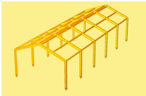
Bild 12. Automatisch generiertes Hallentragwerk Typ B
