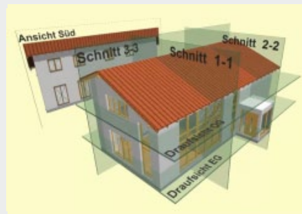
Draufsichten, Schnitte und Ansichten als definierte Ebenen im 3D-Modell
