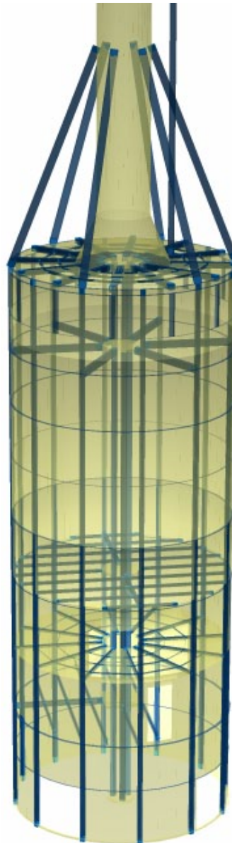
Bild 2. Visualisierte Konstruktion eines Rundfilters mit Kamin
