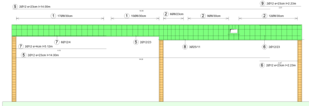
Bild 9. Bewehrungsverlegungen sind eingeblendet
